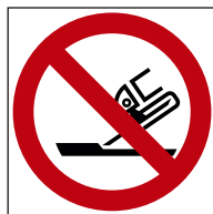
Ref. 434 Prohibido cortar de cara
