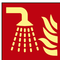
Ref. 41 Dispositivo de disparo de agua nebulizada
