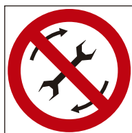
Ref. 482 Prohibido reparar la máquina en funcionamiento
