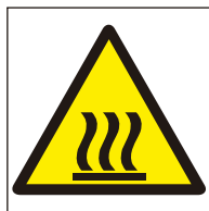
Ref. 379 Peligro Contacto térmico
