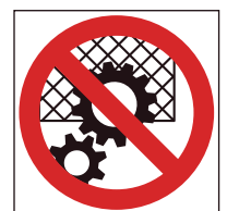
Ref. 477 Prohibido manipular el dispositivo de seguridad
