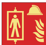
Ref. 17 Ascensor para los servicios de emergencia
