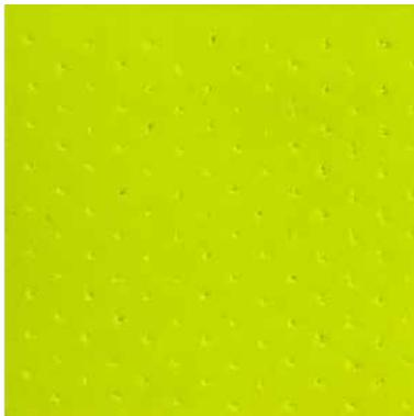
Perforación de tejido reflectante a medio corte. Cualquier ancho.
